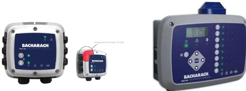
L'MGS402 centralizza le misure per 2 sensori MGS410. E' collegabile via Modbus a uno o due sensori MGS410 e fornisce due uscite analogiche (4..20mA) e 3 uscite a relè. E' dotato di 4 LED frontali per ciascun sensore collegato (3 allarme + 1 funzionamento) piu segnalatore di allarme (visivo/acustico) lungo tutto il perimetro. E' alimentato 220Vac e alimenta direttamente i sensori ad esso collegati
