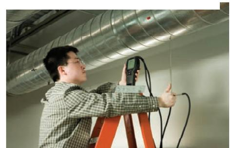
misura di pressione e velocità all'interno di canali, con tubo di pitot
