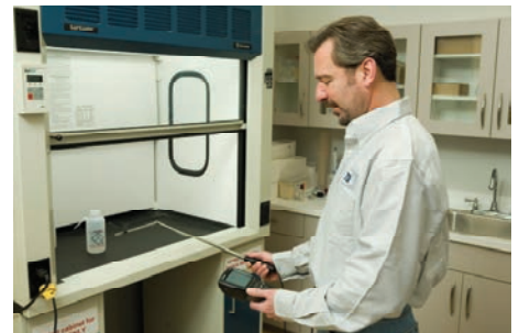
misura di basse velocità con sonda a filo caldo articolata
